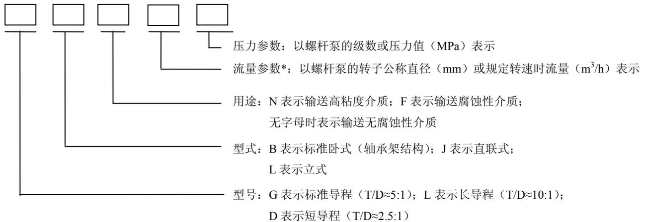
\* 当用转子公称直径表示流量参数时, 以半字线 (即“-”) 连接流量参数和压力参数; 当用规定转速时流量表示时, 以逗号 (即“.”) 连接流量参数和压力参数。
